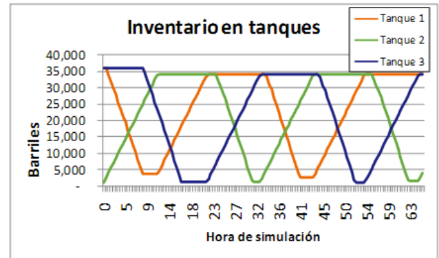
Figura 5: Inventario tanques capacidad de 36.000
