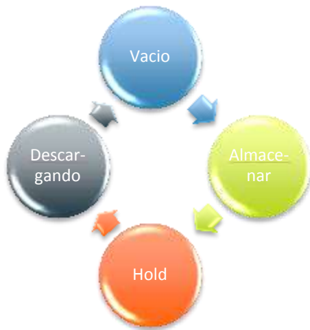
Figura 1: Ciclo de operación de un tanque.
