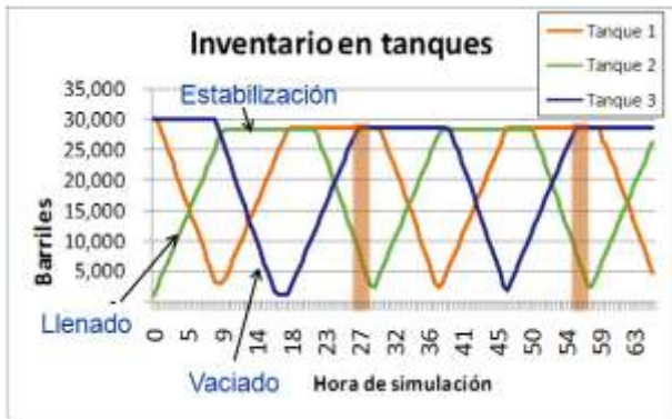
Figura 4: Inventario de los tanques
